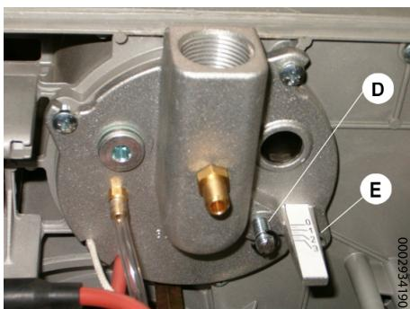
12 - Регулировка открытия дроссельной заслонки
